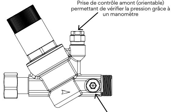
Prise de contrôle amont (orientable) permettant de vérifier la pression grâce à un manomètre.
