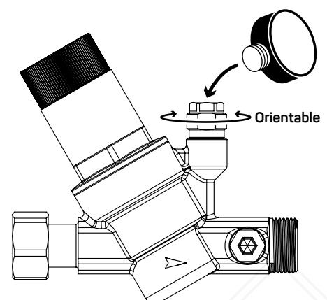
Visser le manomètre (sans forcer) jusqu'en butée pour assurer l'étanchéité.
