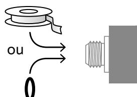
Mettre du ruban PTFE ou un joint torique sur la partie filetée du manomètre.
